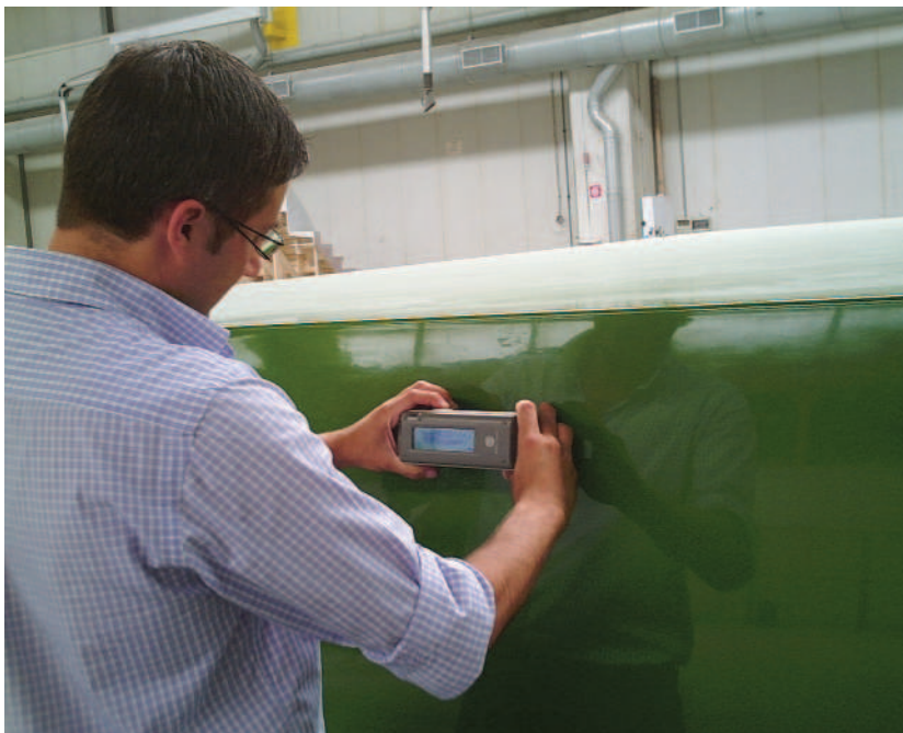
Rilievo del livello di gloss della superficie di uno stampo in VTR
