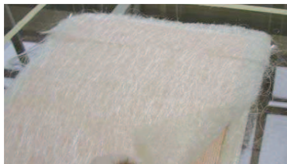
Fig. 4 - 5 Un laminato sandwich: Fibre- PVC- Fibre
