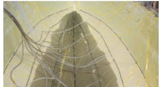
Due immagini del processo di infusione in corso su una coperta (prima figura) e su una carena (seconda figura).
