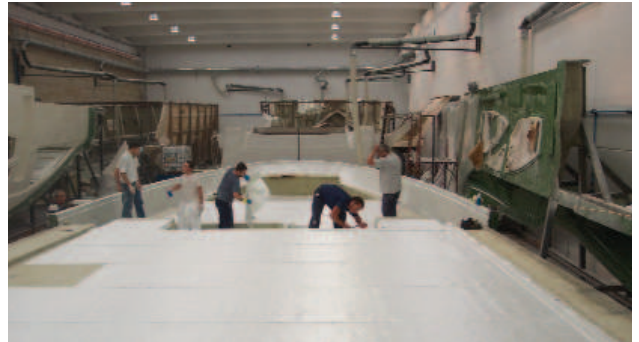
Nelle prime fasi dell'infusione, a differenza della laminazione manuale, le fibre di vetro vengono disposte "a secco" (ossia senza impregnarle con la resina) all'interno dello stampo.
