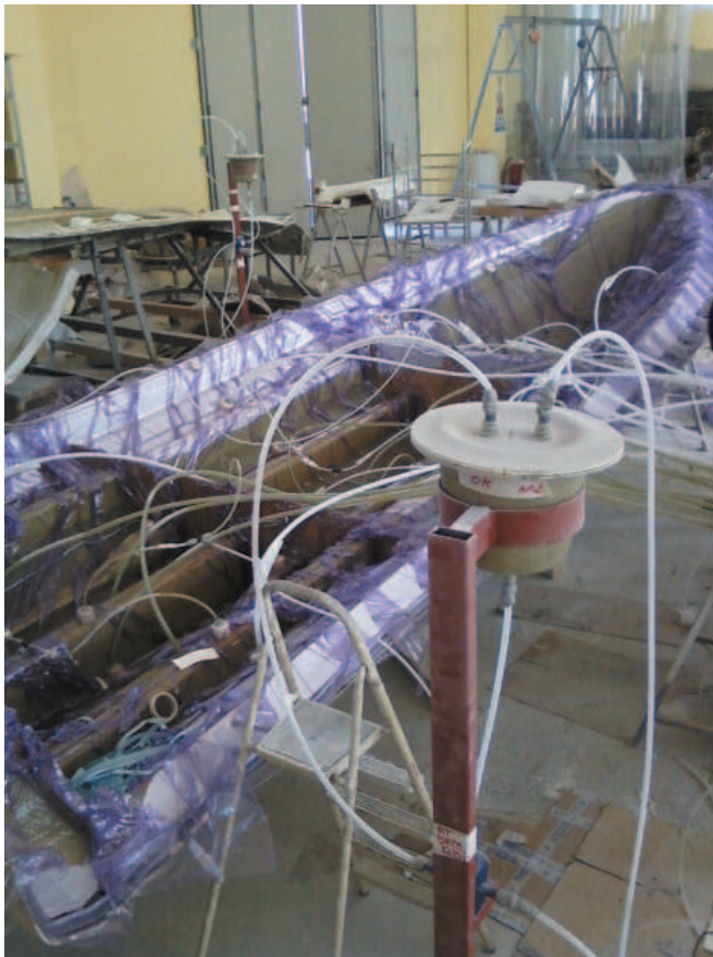
Fig. 2: La realizzazione dell'impianto di infusione
