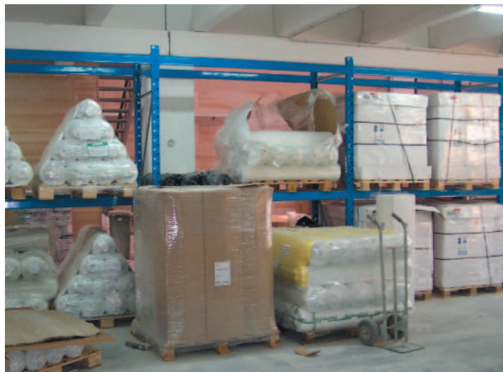
Fig. 2: In un magazzino di Vetro ben gestito, vengono suddivisi ordinatamente: Mat, Woven Roving, Multiassiali. Successivamente si divide ulteriormente ogni sottoinsieme, per grammature.
