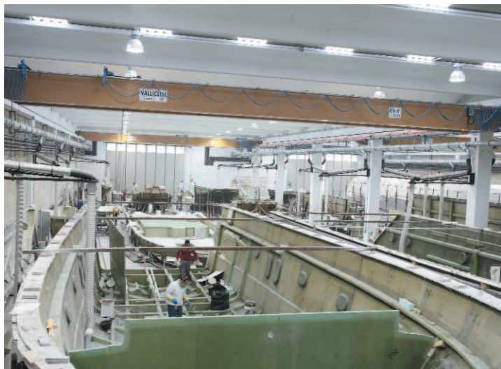
Fig. 1: Un reparto di costruzione maxi yacht, ben organizzato. E' possibile notare in ogni corsia, un modello di yacht. A prua sono collocate le carene, e a seguire le coperte, e infine le rispettive sovrastrutture.
