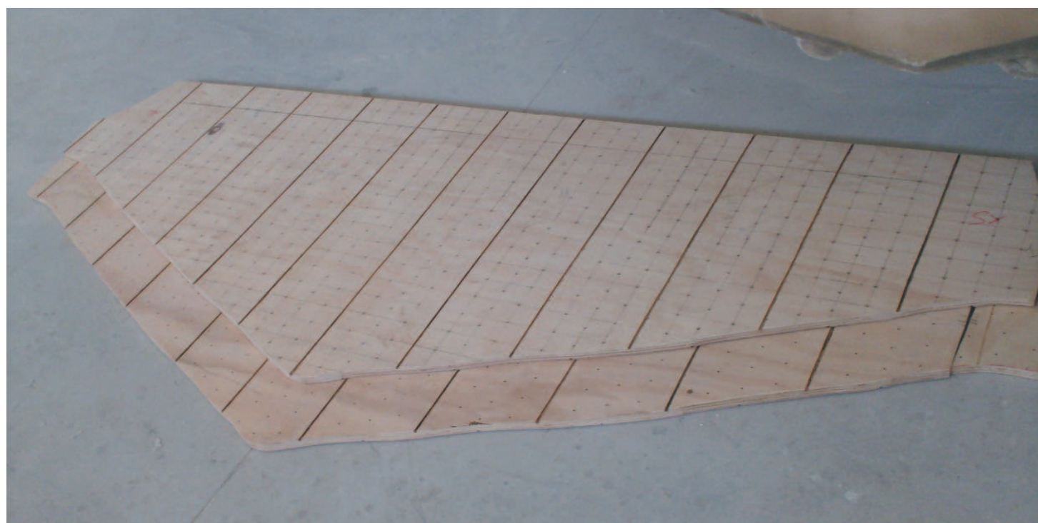
Fig. 3: Con l'ausilio dei macchinari a controllo numerico è possibile predisporre anche tutta la compartimentazione degli interni e la realizzazione dei kit di legno, ottimizzando i tempi e riducendo gli sfridi
