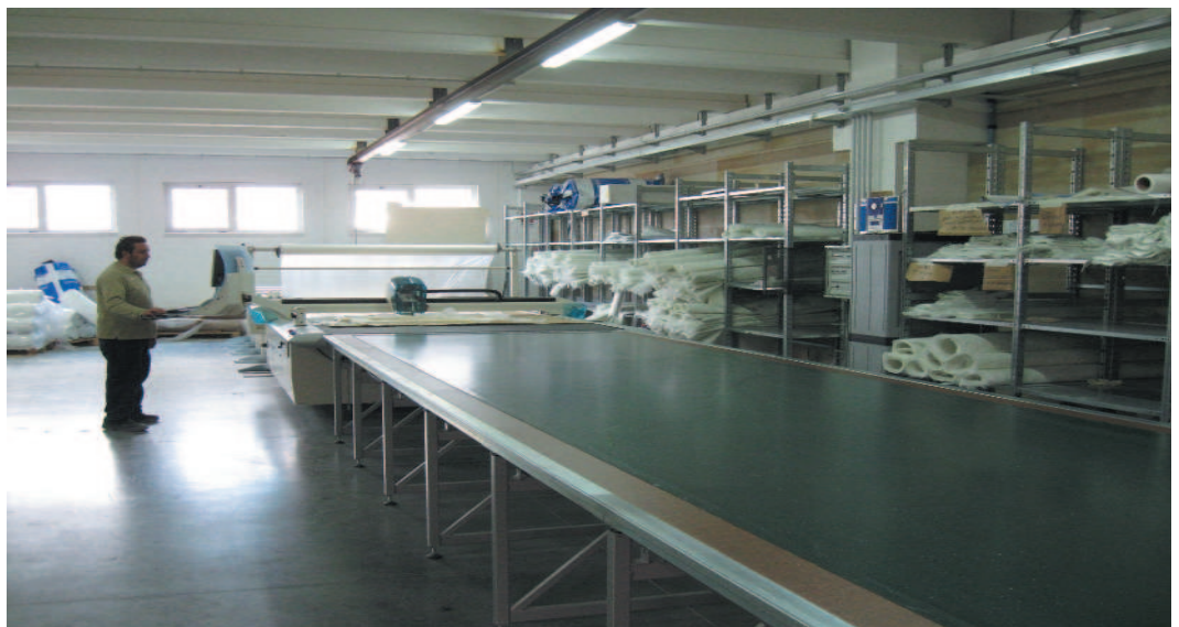
Fig. 2: L'operazione di taglio delle fibre di vetro e dei materiali d'anima, può essere effettuata con macchinari che riducono al minimo gli sfridi di lavorazione
