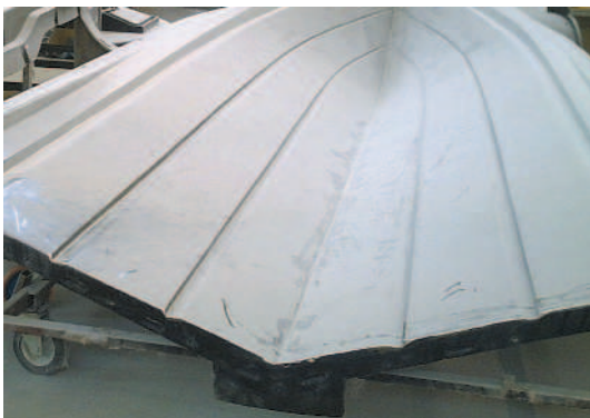
Fig. 2: La preparazione per il gelcoat di uno stampo non protetto comporta l'80% in più delle ore di mano d'opera
