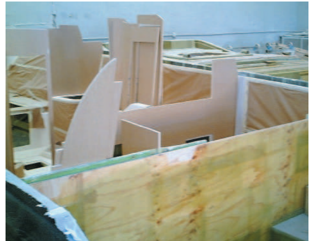
Fig. 1: La compartimentazione degli interni è una delle sotto-fasi che si inseriscono all'interno della catena di produzione di un'imbarcazione
