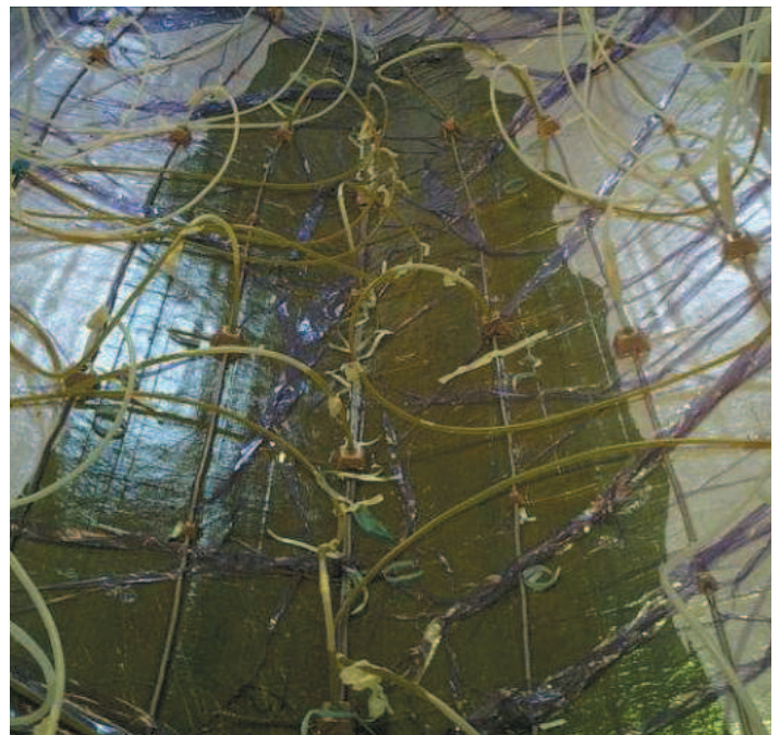
Fig. 4: Durante il processo di bagnatura delle fibre, si può osservare la perfetta simmetria del flusso della resina sintomo di una buona progettazione del lay-out
