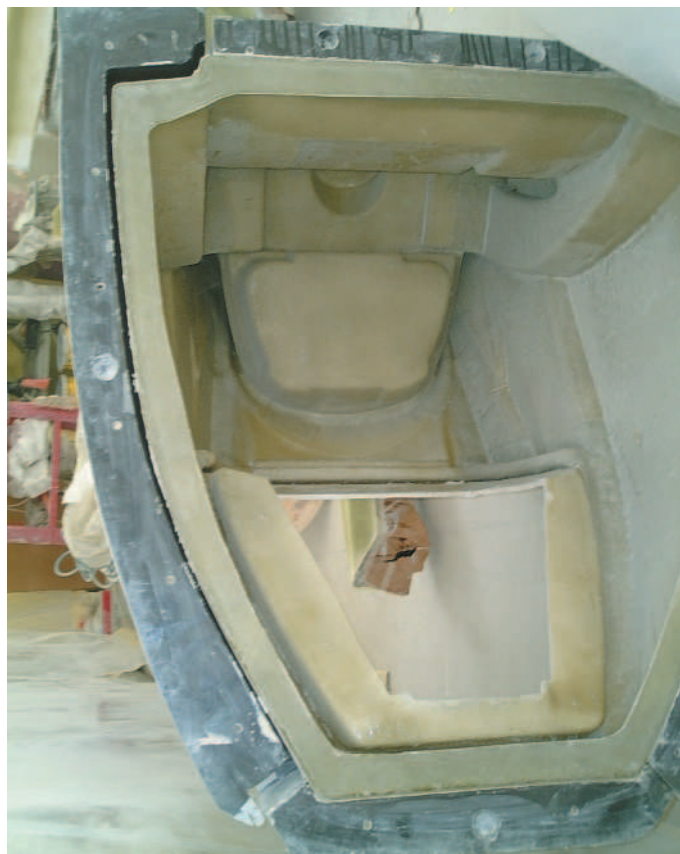
Fig. 1 La stampa di un cassero di guida pronta da sformare e da assemblare
