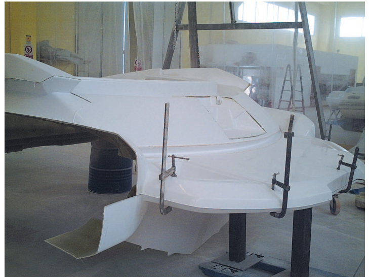
Fig. 3 L'incollaggio delle varie parti che compongono un'imbarcazione
