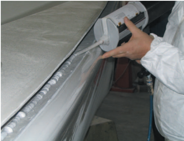
Fig. 2 Incollaggio Strutturale Scafo-Coperta con ADHESYS
