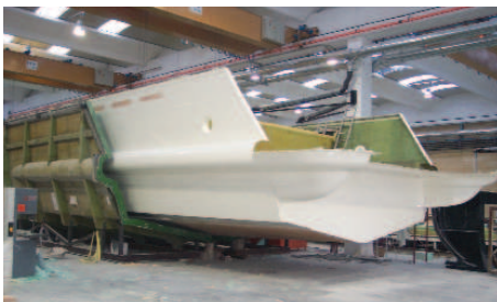
La scocca dello scafo di un'imbarcazione di 30 metri viene "estratta" dal relativo stampo. Una volta "sformata", quest'ultima dovrà essere assemblata con i ponti di coperta e terminata con gli allestimenti e le motorizzazioni.
