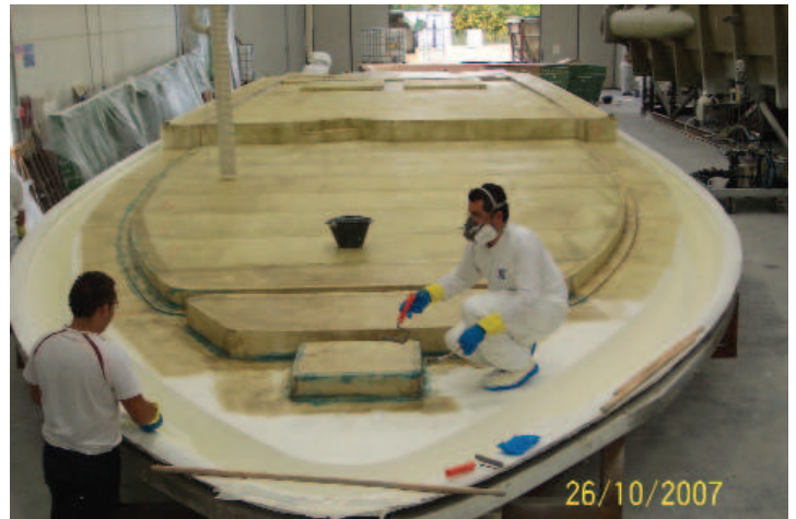
Laminatori durante la fase di impregnazione con resina, della fibra di vetro adagiata nello stampo di un ponte di coperta.
