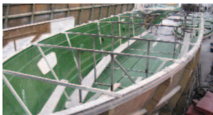
Lo stampo da cui si produce una carena di un'imbarcazione da 24 metri.
