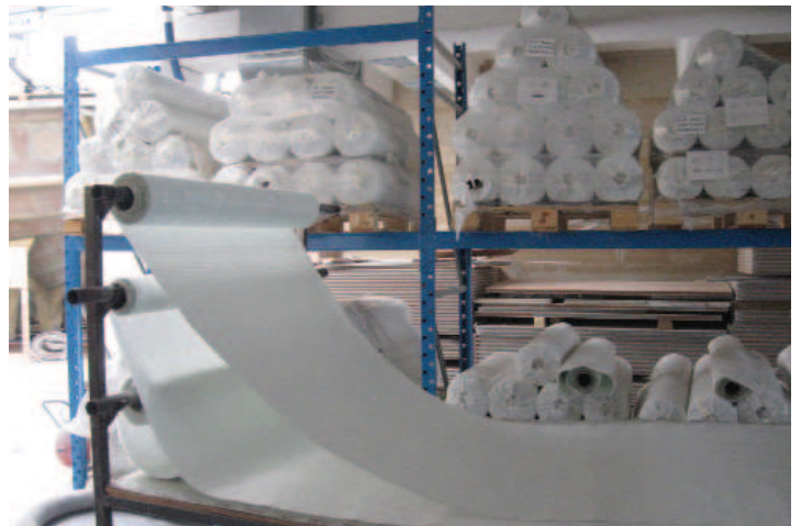
In primo piano, il tavolo di "taglio", su cui si posizionano i vari rotoli che vengono dispiegati e quindi tagliati. Sullo sfondo, invece, si notano i vari tipi di rotoli "stoccati" su apposite incastellature dove viene immagazzinata questa materia prima.
