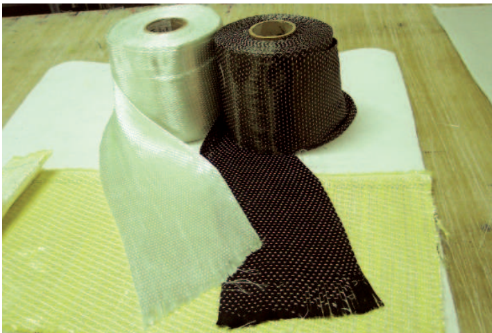
Due rotoli di fibra a confronto. Il rotolo bianco è costituito da fibre di vetro, quello nero da fibre di carbonio.
