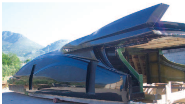
Il Modello in legno verniciato di una tuga di un motoryacht di 30 metri.
