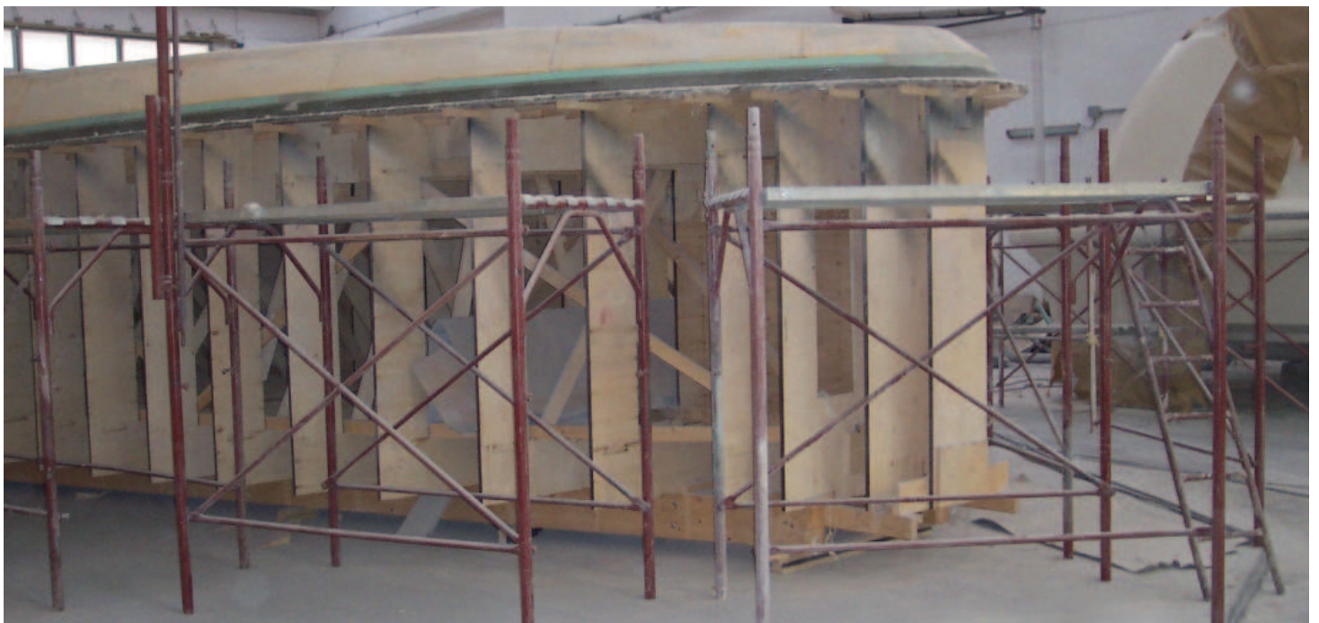
Il modello grezzo di un ponte di coperta. E' possibile vedere le varie ordinate ricoperte dal fasciame in legno.
